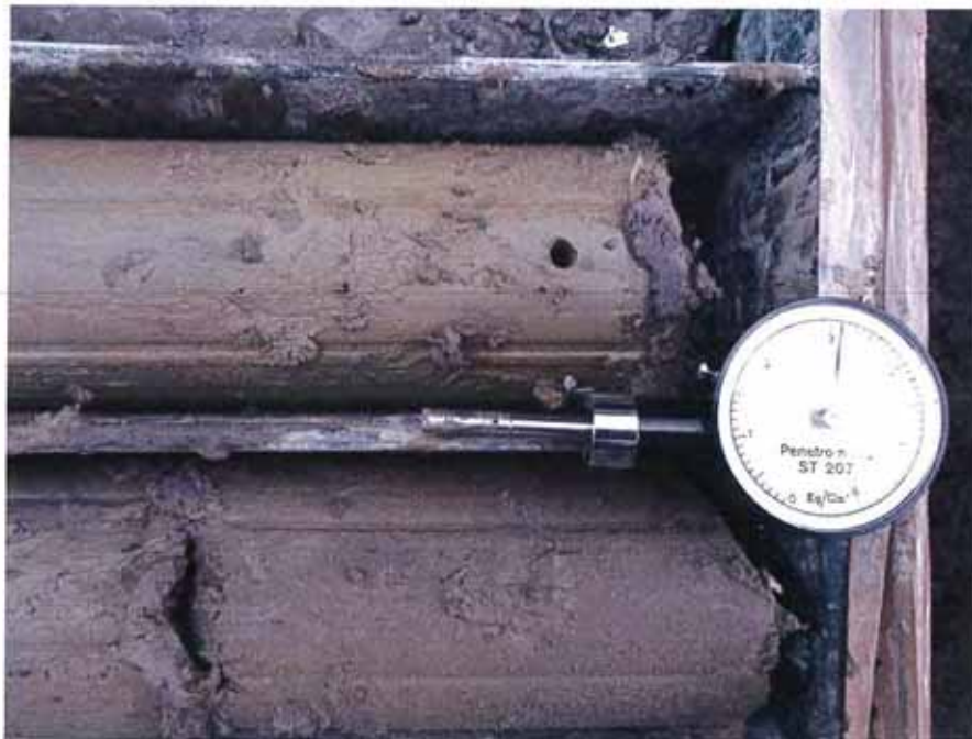
Misurazione n.1 con penetrometro ST 207 della C_U .
