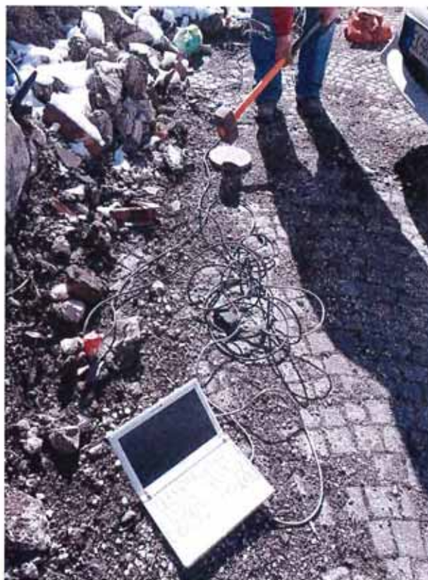
Esecuzione prova sismica M.A.S.W..
