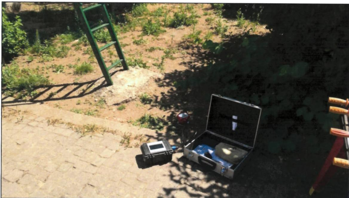
**Foto 5:** fase di acquisizione spettrale della prospezione sismica H.V.S.R.
