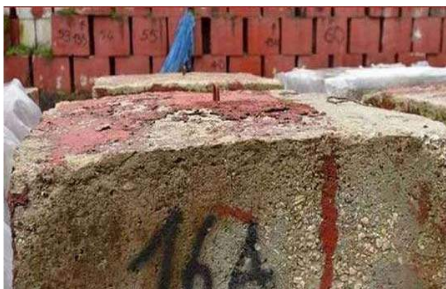
Foto cubi cemento contenuti amianto
